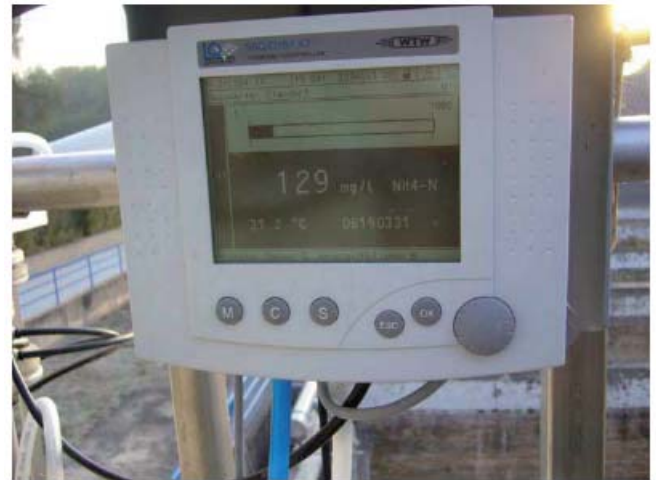
図4. VARION センサーによるNH 4 の測定値
