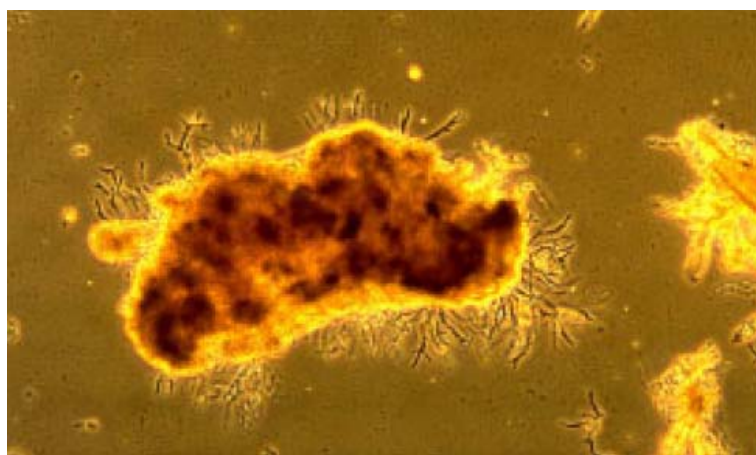
図 3. 活性汚泥の顕微鏡写真。濃い褐色はフロック中でバクテリアの個体数が多い部分を示す。中央の小さいフロックは表面から伸びている糸状菌を示す。隣り合うフロックとは結合していないので、このスラッジはよく沈殿する。
