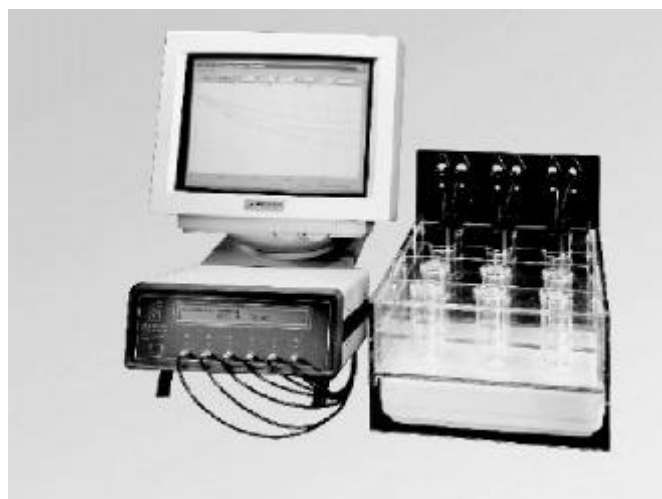
図6 Strathkelvin 社の活性汚泥呼吸度計。6本の酸素電極を用い、専用の呼吸度計測ソフトウェアをインストールしたPCに接続される。
