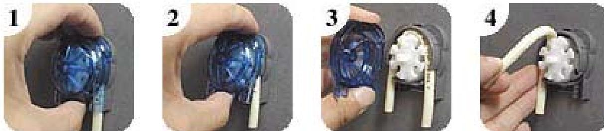
図9 ポンプチューブの取外し
