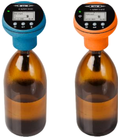
OxiTop用測定ヘッドを試料ビンに取付、十分に締める
