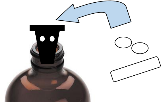
攪拌子を入れた後、ゴムスリーブを差込、NaOHを数粒スリーブに入れる
