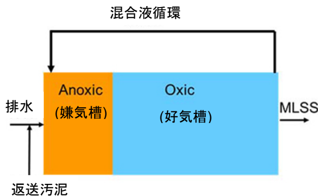
図1 循環式硝化脱窒法 (MLE) 構成のフロー図
