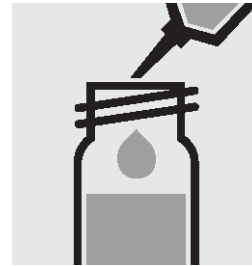
4. ピペットで 1.5ml の試薬 B-2 を加え、ねじふたで閉じます。
