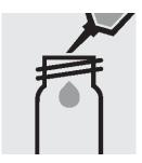
8. ピペットで 5.0ml の前処 理試料をスクリューキャップ 付の丸セルに取ります
