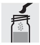
11. 青のミクロスプーンで1 回分の**試薬 CN-4** を加え て、ねじぶたでセルを閉じま
