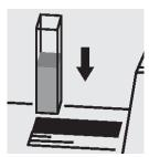
10. 各セルをセルコンパー トメントにセットし、測定しま す。
