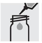
2. ピペットで 5.0ml の試料 を反応セルに取り、ねじぶ たで閉じて、固体物を溶かします。
