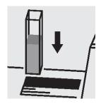
16. 各セルをセルコンパー トメントにセットし、測定しま す。
