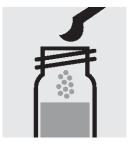
5. 青のミクロスプーンで1 回分の**試薬 CN-4** を加え て、ねじぶたでセルを閉じま す。
