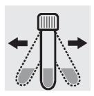
4. セルをよく振とうして、固 5. 反応時間:10 分間 休物を突がします
