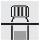
5. リアクターからセルを取 出し、試験管立てに立て て、室温まで放冷します。
