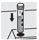
12. 各セルをセルコンパー トメントにセットし、測定しま す。セルのマークを光度計 のマークに合わせます。
