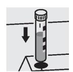
6. 各セルをセルコンパート メントにセットし、測定しま す。セルのマークを光度計 のマークに合わせます。
