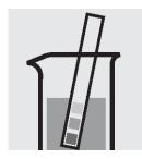
1. 試料の pH が pH 4.5~ 8.0 であるかチェックします。 必要な場合、水酸化ナトリ ウム水溶液または硫酸を1 滴ずつ加えて、pH を調整し ます。
