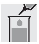
4. ピペットで 8.0 ml の試 料を加えて攪拌します。
