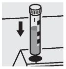
3. 各セルをセルコンパート メントにセットし、測定しま す。セルのマークを光度計 のマークに合わせます = 測定値 B
