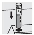
4. 各セルをセルコンパート メントにセットし、測定しま す。セルのマークを光度計 のマークに合わせます。
