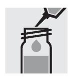
1. ピペットで 1.0ml の試料 を反応セルに取ります。攪 拌しないでください。
