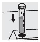
5. 各セルをセルコンパート メントにセットし、測定しま す。セルのマークを光度計 のマークに合わせます。
