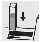
8. 各セルをセルコンパート メントにセットし、測定しま す。
