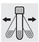
2. セルを 1 分間よく振っ て、固体物を溶かします。
