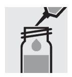
1. ピペットで 1.0ml の試薬 NO<sub>3</sub>-1K を反応セルに取り ます。**攪拌しないでくださ**
