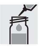
2. ピペットで 0.10 ml の試料を加え、ねじぶたでセルを閉じて攪拌します。注意、セルは高温になります。
