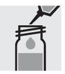
2. ピペットで 1.0 ml の試 料を加えます。 ューキャップ付の丸セル(空 注意、セルは高温になりま す。
