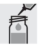
3. **直ちに**ピペットで 1.5ml の試薬 NO<sub>3</sub>-2 を加えま す。
