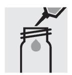
1. ピペットで 5.0 ml の試 薬 NO3-1 を乾燥したスクリ のセル、CAT 番号 250621)に取ります。
