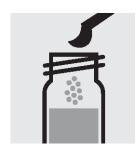
6. グレーのミクロスプーン で2回分の**試薬 NO<sub>3</sub>-3**を 加えます。
