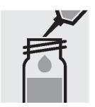
2. ピペットで 1.0ml の試薬 3. 反応時間: 10 分間 NO₃-1K を加え、ねじぶた でセルを閉じて攪拌します。 注意、セルは高温になりま す。
