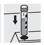
4. 各セルをセルコンパート メントにセットし、測定しま す。セルのマークを光度計 のマークに合わせます。
