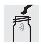
1. 青のミクロスプーンで1 回分の**試薬 NO<sub>3</sub>-1** をスク リューキャップ付の丸セル (品番 M1147240001)に入 す。 れます。
