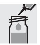
2. ピペットで 1.0ml の試薬 3. 反応時間: 10 分間 NO<sub>3</sub>-1K を加え、ねじぶた でセルを閉じて攪拌します。 注意、セルは高温になりま す。
