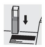
11. 各セルをセルコンパー トメントにセットし、測定しま す。
