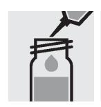
1. ピペットで 0.50 ml の試 料を反応セルに取ります。 攪拌しないでください。
