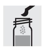
1. 黄色のミクロスプーンで 1回分の**試薬 NO<sub>3</sub>-1K**を 反応セルに加えて、ねじぶ たで閉じます。
