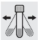
4. セルをしっかり閉じて、よ 5. 反応時間:15分間 く振り混ぜてください。
