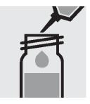
3. ピペットで 0.50ml の試 薬 NO<sub>3</sub>-2 を加え、ねじぶた でセルを閉じて攪拌します。 注意、セルは高温になりま
