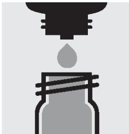
6. 試薬 O<sub>2</sub>-2K を 5 滴加え、ねじぶたでセルを閉じて、10 秒間振ります。
