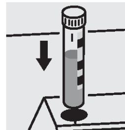
9. 各セルをセルコンパートメントにセットし、測定します。セルのマークを光度計のマークに合わせます。
