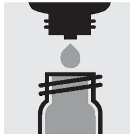
8. 試薬 O<sub>2</sub>-3K を 10 滴加え、ねじぶたでセルを閉じて攪拌し、外側を拭きます。
