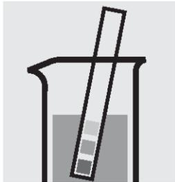
1. 試料の pH が pH 6~8 であるかチェックします。必要ならば、水酸化ナトリウム水溶液または硝酸を 1 滴ずつ加えて、pH を調整します。
