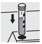
7. 各セルをセルコンパート メントにセットし、測定しま す。セルのマークを光度計 のマークに合わせます。
