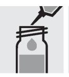
料を反応セルに取り、ねじ ぶたで閉じて攪拌します。
