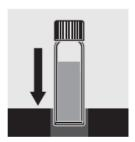
7.2 分間反応させ、直ちに 8. セルをセルコンパートメ ントにセットし、測定します。
