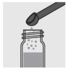
5. 青のミクロスプーンで1 回分の**試薬 SO<sub>4</sub>-2** を加え て、ねじぶたでセルを閉じて 攪拌します。
