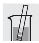
1. 試料の pH が pH 2~10 2. ピペットで 2.5 ml の試 であるかチェックします。 必要ならば、水酸化ナトリ ウム水溶液または塩酸を1 滴ずつ加えて、pH を調整し ます。
