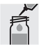
2. ピペットで 1.0 ml の試 料を反応セルに取り、ねじ ぶたで閉じて攪拌します。
