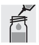
2. ピペットで 1.0 ml の試 料を反応セルに取り、ねじ ぶたで閉じて攪拌します。
