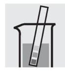
1. 試料の pH が pH 3~9 であるかチェックします。 必要ならば、水酸化ナトリ ウム水溶液または塩酸を1 滴ずつ加えて、pH を調整し ます。
