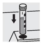
5. 各セルをセルコンパート メントにセットし、測定しま す。セルのマークを光度計 のマークに合わせます
