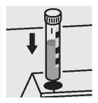
す。セルのマークを光度計 のマークに合わせます = マグネシウム測定値
