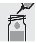
4. ピペットで 0.50ml の**試薬 Zn-2K** を反応セルに取り、ねじぶたで閉じて攪拌します
