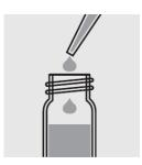
3. ピペットで 0.50 ml の試 料を加え、ねじぶたでセル を閉じて攪拌します。
