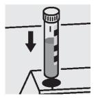
8. 各セルをセルコンパート メントにセットし、測定しま す。セルのマークを光度計 のマークに合わせます。
