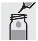
5. ピペットで 2.0ml の**試料**-**試薬混合液**を加え、ねじぶたでセルを閉じて攪拌しま
