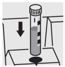
各セルをセルコンパートメントにセットし、測定します。セルのマークを光度計のマークに合わせます。
