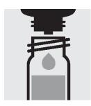
反応セルに**試薬 Zn-1K** を5滴加え、ねじぶたで閉じて攪拌します。
