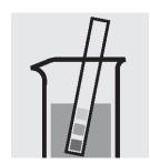
1. 試料の pH が pH 1~7 であるかチェックします。 必要ならば、水酸化ナトリウム水溶液または塩酸を 1 滴ずつ加えて、pH を調整します。
