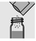
ヌル酸塩 F10 粉末パックの 体物を溶かします。 中身を加え、ねじぶたでセ ルを閉じます。
