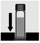
7. セルを光度計セルシャフ トに挿入し、測定を開始して ください。
