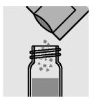
4.4 分間、反応させてくださ 5. VARIO 無水ケイ酸クエ ン酸 F10 粉末パックの中 身を加え、ねじぶたでセル を閉じます。
