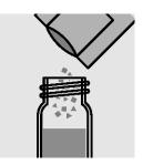
クエン酸 F25 粉末パックの 中身を混合します。 中身を加え、ねじぶたでセ ルを閉じます。
