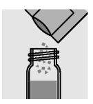
モリブデン酸塩 F10 粉末パ 中身を混合します。 ックの中身を加え、ねじぶ たでセルを閉じます。
