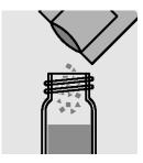
4. VARIO 無水ケイ酸 HR **酸試薬 F10** 粉末パックの 中身を加え、ねじぶたでセ ルを閉じます。
