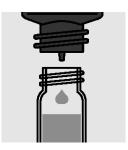
2. Vario モリブデン酸塩 3 試薬溶液を15滴加えて、 ねじぶたでセルを閉じま
