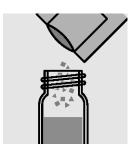
モリブデン酸塩 F25 粉末パ 中身を混合します。 ックの中身を加え、ねじぶ たでセルを閉じます。
