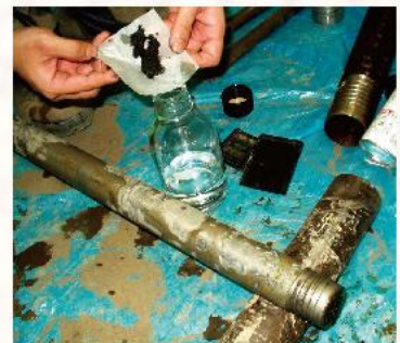
●土壌汚染調査 (土壌採取例：ボーリング孔)
