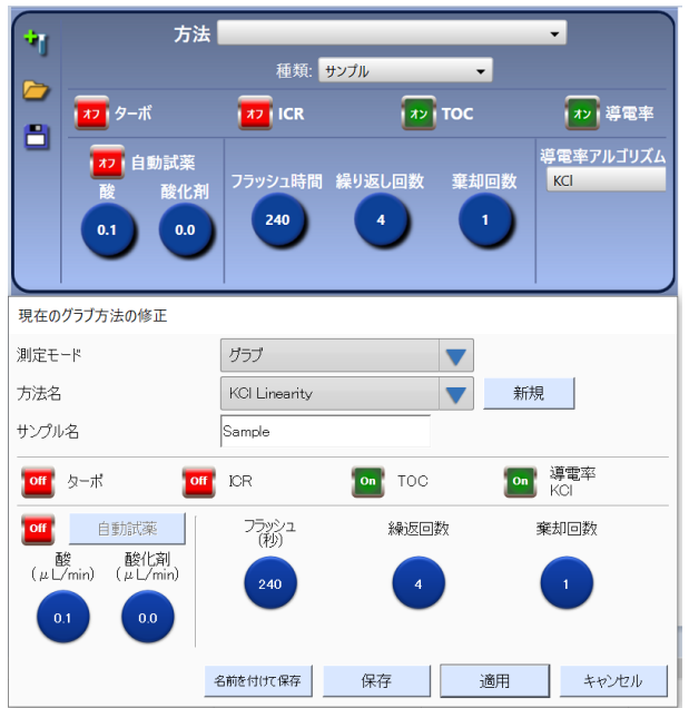
図 1. Sievers M9 型でサンプル導電率を測定する際の測定条件
