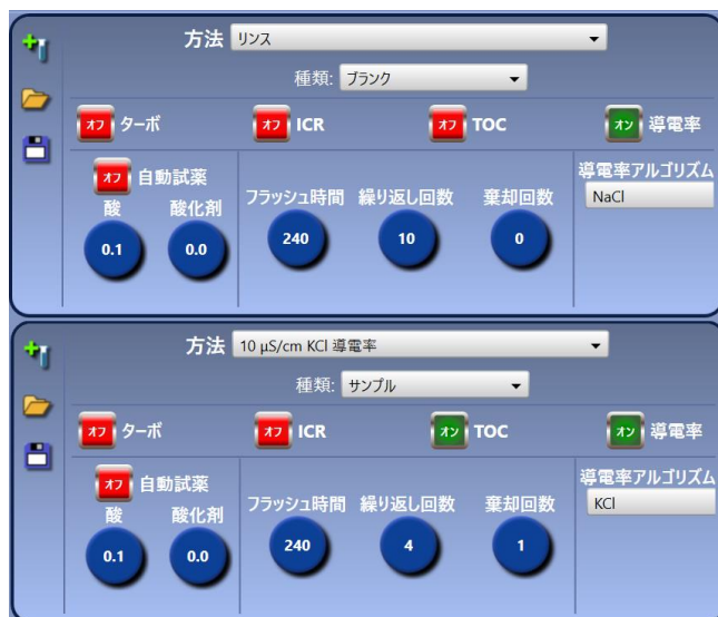
図2. A : ブランクの測定条件 B : 10 \mu S / cm 導電率標準液の測定条件
