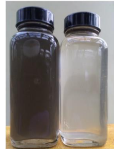
加圧浮上処理設備の流入原水(左)と処理水(右)
