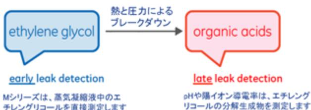
図1. TOC計 Sievers Mシリーズは、エチレングリコールを直接測定し、pHや導電率よりも早くリークを検出できます
