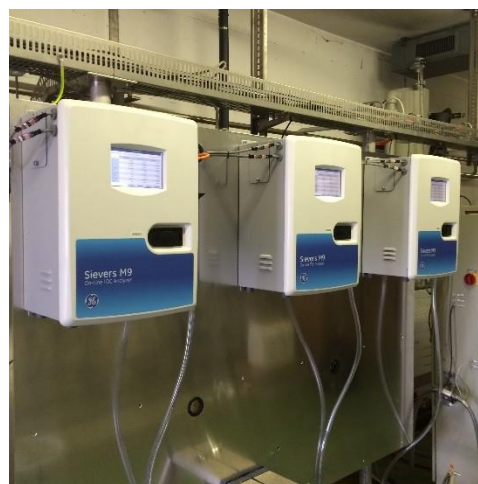
図1: 冷却排水をモニタリングする3台のSievers M9オンライン型TOC計
