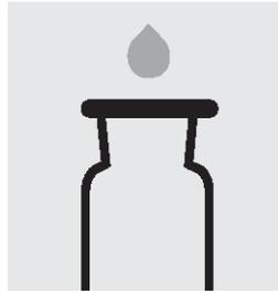
2. 2 本の反応ボトルに前処理済試料を気泡が入らないように満たし 2 個のガラスビーズを加えてガラス栓をします。
