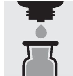
9. 試薬 BSB-3K を 10 滴加え、再び栓をして攪拌します。
