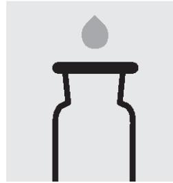
3. 2 本の反応ボトルに植種希釈液を気泡が入らないように満たし 2 個のガラスビーズを加えてガラス栓をします。
