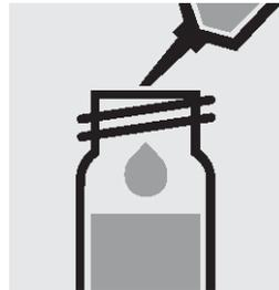
3. ピペットで 8.0ml の試料を加え、ねじぶたで閉じます。
