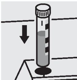
6. 各セルをセルコンパートメントにセットし、測定します。セルのマークを光度計のマークに合わせます。
