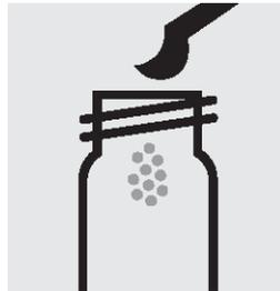
2. 青のマイクロスポーンで 2 回分の試薬 NO<sub>2</sub>-1K を反応セルに加えます。
