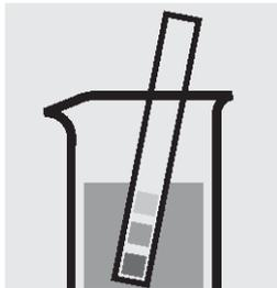
1. 試料の pH が pH 1~12 であるかチェックします。必要ならば、希硫酸を 1 滴ずつ加えて、pH を調整します。
