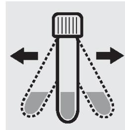
4. セルをよく振とうして、固体物を溶かします。
