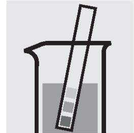
5. 試料の pH が pH 2.0~2.5 であるかチェックします。必要な場合、水酸化ナトリウム水溶液または硫酸を 1 滴ずつ加えて、pH を調整します。
