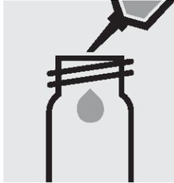
2. ピペットで 5.0ml の試料を反応セルに取り、ねじぶたで閉じます。
