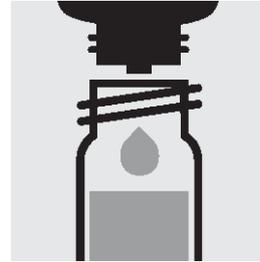
5. 試薬 K-1K を 6 滴加え、ねじぶたでセルを閉じて攪拌します。
