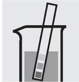
2. 試料の pH が pH 3~12 であるかチェックします。必要な場合、水酸化ナトリウム水溶液または硫酸を 1 滴ずつ加えて、pH を調整します。
