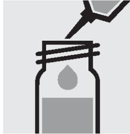
3. ピペットで 0.50 ml の試料を反応セルに取り、ねじぶたで閉じて攪拌します。
