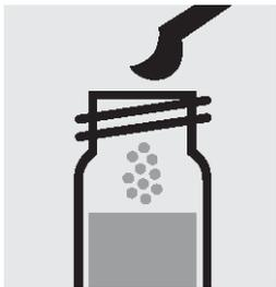
6. 青のマイクロスポーンで 1 回分の試薬 K-2K を加えて、ねじぶたでセルを閉じます。
