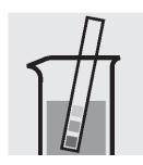
1. 試料の pH が pH 4~10 2. ピペットで試料 10 ml を 3. **試薬 Ag-1** を 2 滴加え であるかをチェックします。 必要な場合、水酸化ナトリ ウム水溶液または硫酸を1 滴ずつ加えて、pH を調整し ます。
