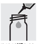
12. 1.0ml の試薬 Ag-6 を 加え、ねじぶたで閉じて攪 拌します。
