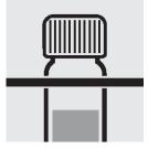
6. リアクターからセルを取 出し、試験管立てに立て て、室温まで放冷します。
