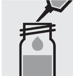
2. ピペットで0.50 mlの試料を加え、ねじぶたでセルを閉じて攪拌します。
