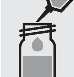
1. ピペットで0.50mlの試薬 Na-1Kを反応セルに取って攪拌します。
