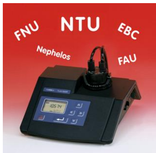
WTW ラボ用濁度計「Turb 555」
