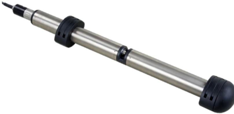
IQセンサーネットセンサー『UV 700IQ SAC』は、サンプル水中にセンサーを浸漬し、単波長のUV光の吸光度からSAC（スペクトル吸収係数）を求めることにより、サンプル水に含まれる有機物濃度を測定します。『UV 700IQ NO<sub>x</sub>』は同様な測定原理により、NO<sub>x</sub>（硝酸と亜硝酸の合計）を測定します。これらのセンサーを用いることにより、試薬を使用せずにリアルタイムで汚濁負荷量や窒素負荷量をモニターすることができます。下水処理場における流入水や放流水の水質の変化をモニターしたり、河川や湖沼中の有機物濃度やNO<sub>x</sub>濃度を測定するために用いられます。
